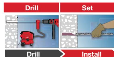
Observação: OSHA 1926.1153 Os métodos de controle da Tabela 1 exigem um aspirador com 99% de eficiência de filtro e um mecanismo de limpeza de filtros — Um HEPA não é necessário
