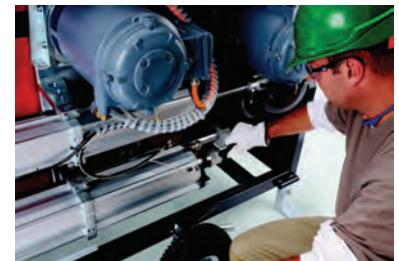
17. قم بتحريك مانع بدء التشغيل حتى أسطوانة الهواء المضغوط تماما وقم بتنبيهه.
