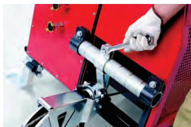
12. قم بتحريك بكرة التوجيه السفلية إلى مستوى الاستخدام المناسب وقم بتنبيتها بالبرغي (حزوز التمييز سهل عملية تحديد الموضع بشكل دقيق).
